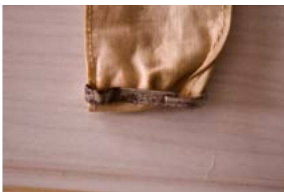
Figuur 3: Gecorrodeerde haakjes vervuilen textiel bij contact
